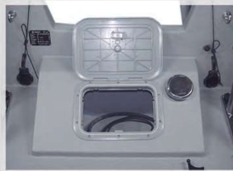
TAMBUCHO POPA C/AIREACIÓN DEPÓSITO
