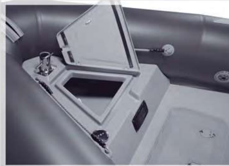
TAMBUCHO PROA C/TOMA LLENADO DEPÓSITO
